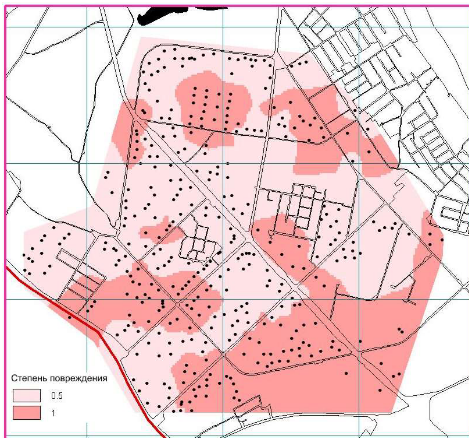
Рис.9. Карта повреждений сейсмостойких зданий в микрорайоне Ботаника со снятым резонансным эффектом (31.08.86).
