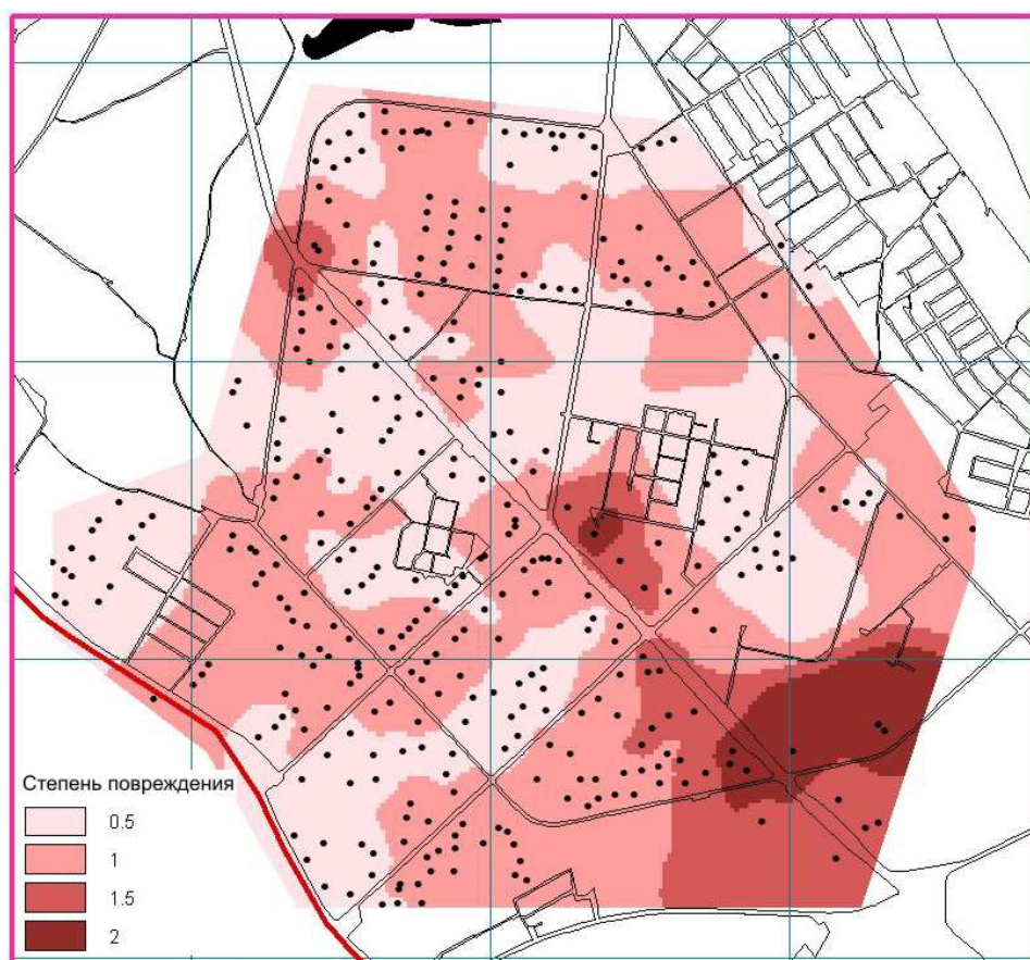
Рис.8. Карта повреждений сейсмостойких зданий в микрорайоне Ботаника при землетрясении 31.08.86 г.
