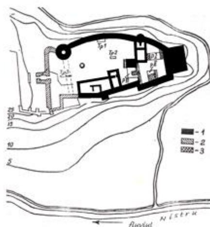
PLANUL CETĂȚII HOTIN (după B. Timoșciuk) 1. Ziduri din secolul XV. 2. Ziduri din secolul XVI. 3. Vestigii din secolul XV, descoperite arheologic
