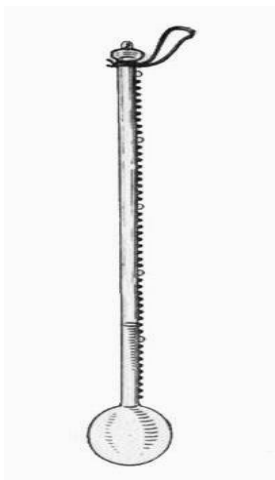
Fig. 5. Termometrul cu lichid Medici [3]
