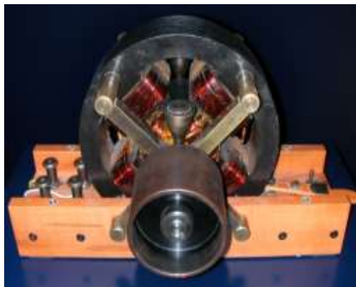
Fig.3.Model al unui generator electric de curent alternativ al lui Nikola Tesla
