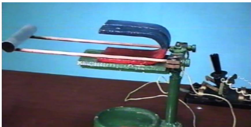
Fig. 4. Demonstrarea forței Ampere (cilindrul este deviat în stînga)
