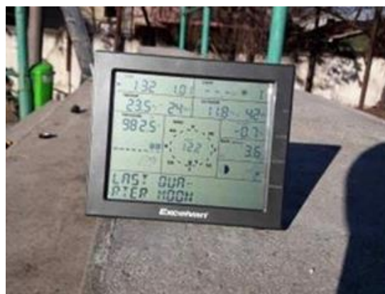
Figura 3 Stația propriu-zisă, având conexiune wi-fi pe o distanță de 100 m
