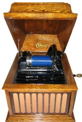
Fig. 18. Fonograf model AMBEROLA 30 Producător: Thomas A. Edison Inc. , Oregon, New Jersey, SUA, 1915-1920 (piesă din patrimoniul Muzeul Științei și Tehnicii „Ștefan Procopiu” Iași)
