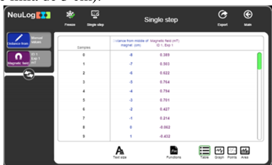
Fig 1.14. Rezultatele măsurărilor variației câmpului magnetic de distanță
