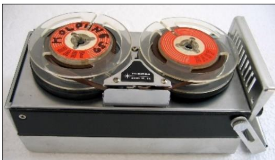
Fig.24. Mini- magnetofon portabil cu tranzistori Sony, Japonia, c.1970 (piesă din patrimoniul Muzeului Științei și Tehnicii „Ștefan Procopiu” Iași)
