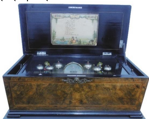
Fig. 11. Cutie muzicală tip orchestră, suport de înregistrare cilindru cu pini cu 12 melodii, Geneva, Elveția, 1880 (piesă din patrimoniul Muzeul Științei și Tehnicii „Ștefan Procopiu” Iași)
