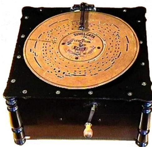
Fig.16. Organetă ARISTON Producător: Fabrik Leipziger Musikwerke, Leipzig, Germania, ca.1895 (piesă din patrimoniul Muzeul Științei și Tehnicii „Ștefan Procopiu” Iași)
