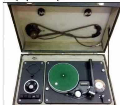
Fig. 23. Combină muzicală SCAHUB (magnetofon cu fir de oțel și picup) Producător: Reichhalter & Co. Lindau, Germania, 1952 (piesă din patrimoniul Muzeului Științei și Tehnicii „Ștefan Procopiu” Iași)
