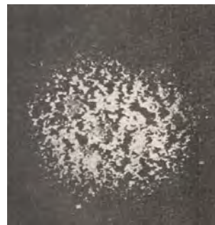
Рис. 1. Образец водной суспензии частиц оксида иттрия, недоизмельченных при произвольно выбранном режиме электроразрядной обработки.
