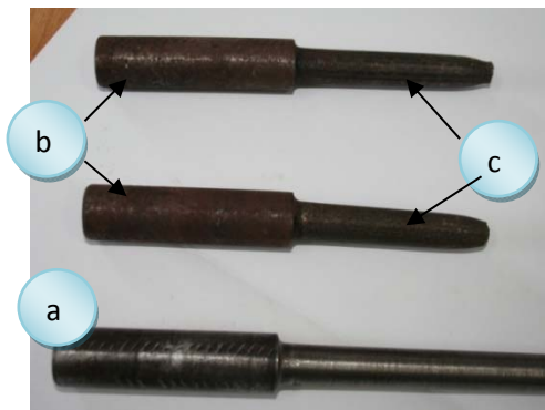
Figura 5. Vederea generală a probelor supuse coroziunii în atmosferă, în condiții de laborator, timp de 3 ani: a – starea inițială; b – suprafața fără depunere; c – suprafață cu depunere de grafit.
