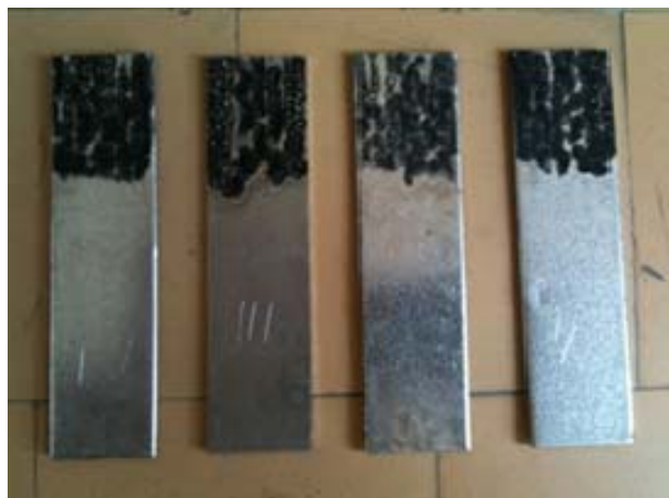
Figura 6. Epruvete cu peliculă de grafit.
