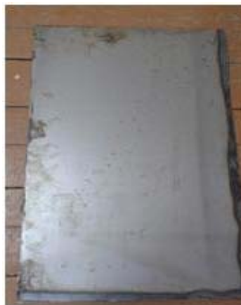
Figura 1. Format de tablă de ambutisare de 800x600x2 mm.
