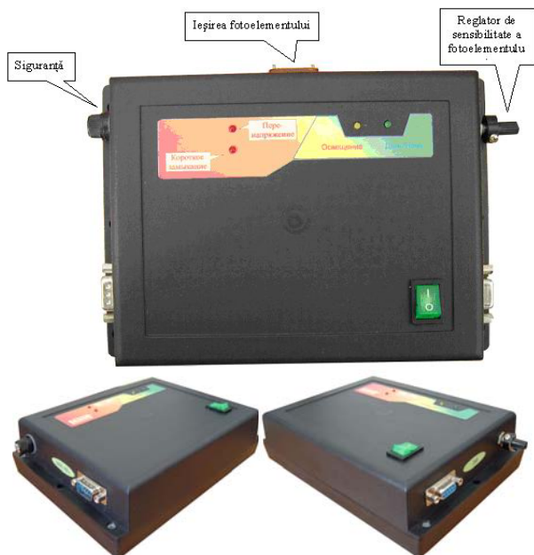
Figura 11. Imaginea modulului de comandă și control, intrările și ieșirile
