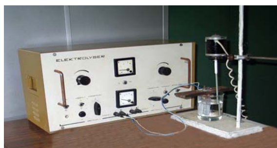
Figura 1. Instalația utilizată pentru realizarea ACE
