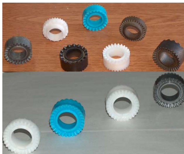
Figura 4 Roți dințate satelit turnate din diferite materiale plastice.
