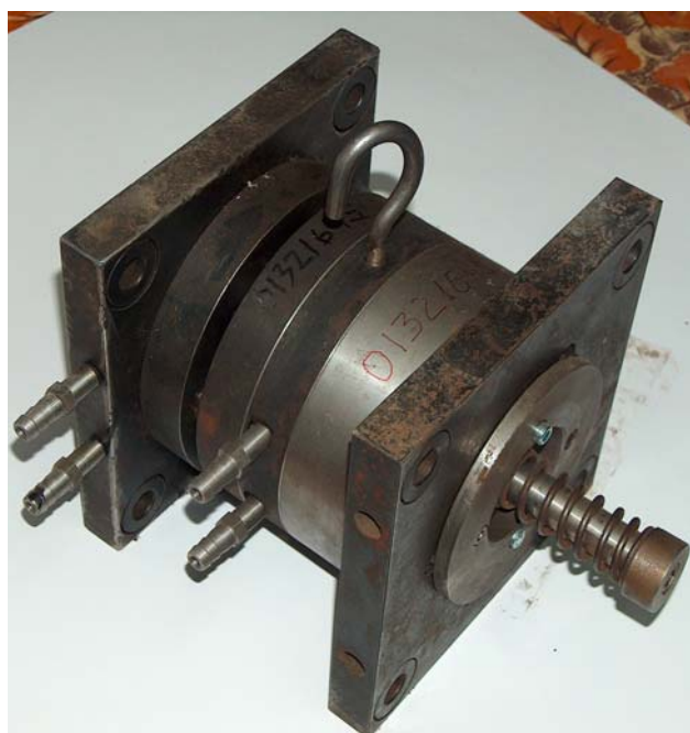
Figura 2 Forma de turnare a roții satelit executată în metal.
