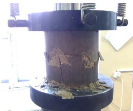
Figura 2. Determinarea rezistenței la compresiune axială.
