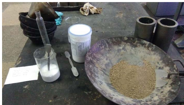
Figura 1. Confecționarea mostrelor de sol cu adaos de liant mineral și copolimer acrilic.
