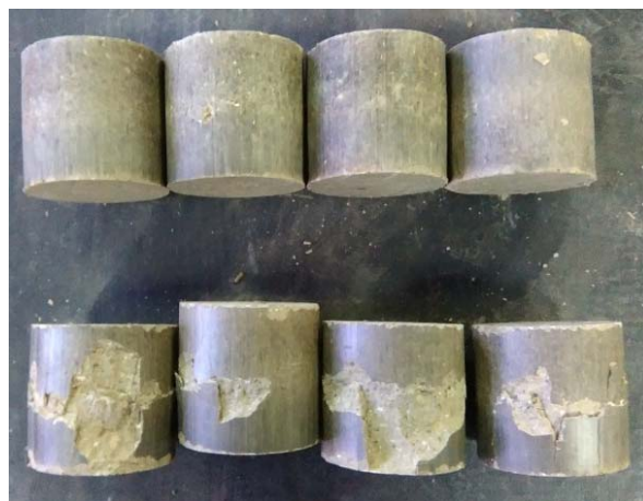
Figura 5. Distrugerea mostrelor după încercarea la compresiune axială. „Sus ” – pământ cu adaos de ciment și copolimer acrilic; „Jos ” – pământ cu adaos doar de ciment.
