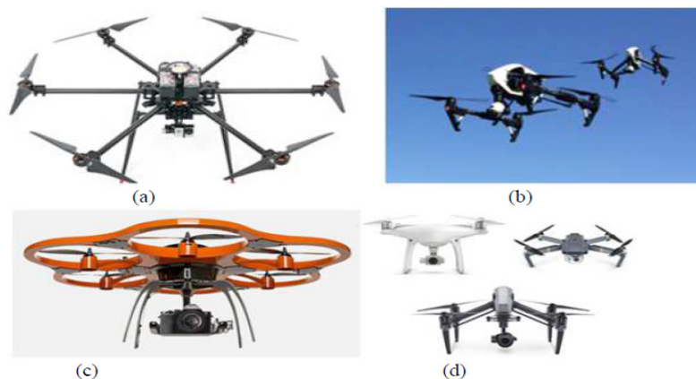
Fig.2 Tipuri de drone multi-rotor cu camere digitale fotogrammetrice.
