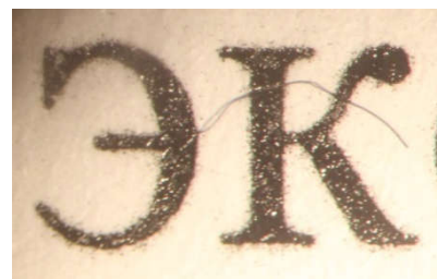
Изоб. №3 Волокно черного цвета, следы отслоения микрочастиц тонера при непосредственном контакте с теплоносителем
