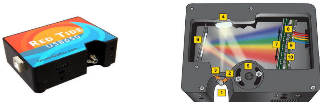
Fig. 1. Reprezentarea schematică a montajului experimental de măsurare prin metoda spectroscopiei digitale. a) Spectrometru RED TIDE USB650 . b) Părți componente: 1- Conector SMA; 2- Fanta; 3- Filtru neutru; 4- Oglindă colimatoare; 5- Grilaj; 6- Oglinda de focusare; 7- Lentilă; 8- Detectorul UV-VIS-IR.
