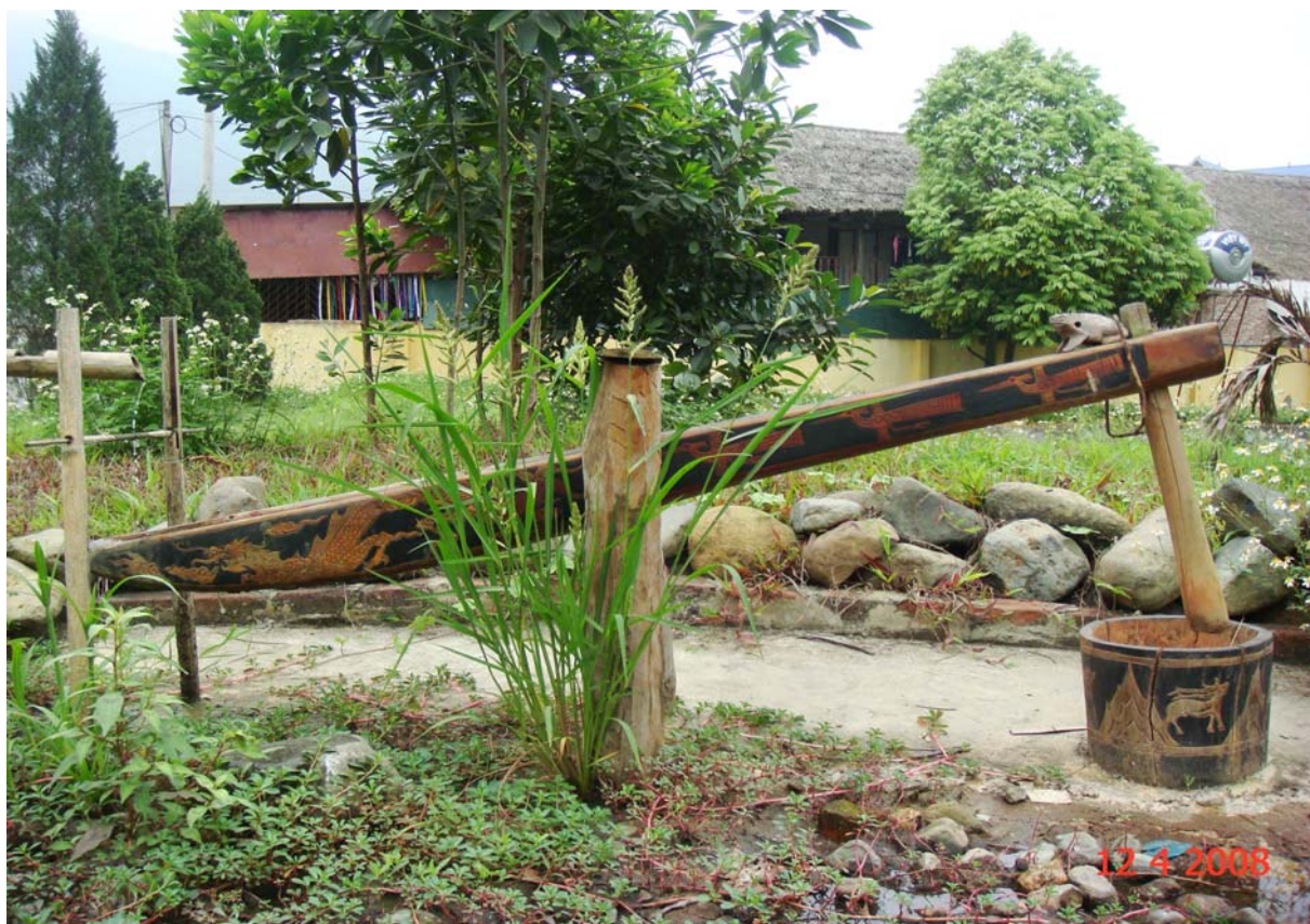
Figura 1 Piuă hidraulică de decorticat orezul
