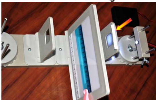
Fig. 1B Aranjament pentru observarea birefrinței în riglă
