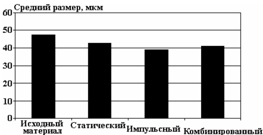
Рис. 6. Зависимость среднего размера зёрен сплава 6111 от способа нагружения
