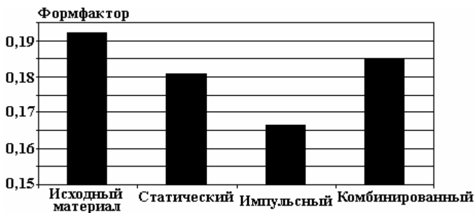
Рис. 9. Зависимость формфактора зёрен сплава 6111 от способа нагружения
