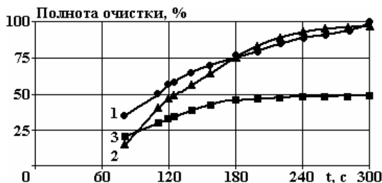
Рис. 3. Зависимость максимально полученной полноты очистки отливок от времени их электроразрядной обработки в различных разрядных средах. 1 – ЭР очистка в воде с предварительным выщелачиванием; 2 – ЭР очистка в адипиновой кислоте; 3 – ЭР очистка в воде без разупрочнения
