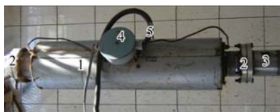
Рис. 19. Электроплазмолизатор в технологической линии по переработке винограда: 1 – корпус; 2 – фланцы; 3 – мезгопровод технологической линии; 4 – клеммная коробка; 5 – кабель электропитания.
