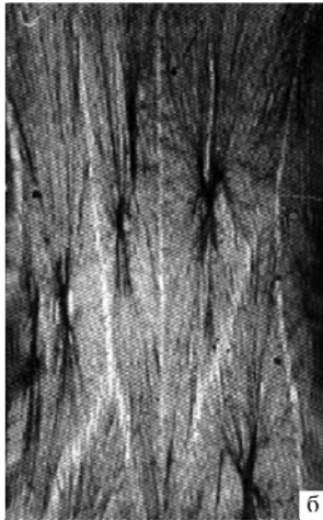
Рис. 7. Электронно-микроскопический снимок неориентированных образцов ПВДФ, обладающих сферолитной структурой (а); изменение структуры при одноосном деформировании исходных образцов \epsilon , %: (б) – 60, (в) – 400.
