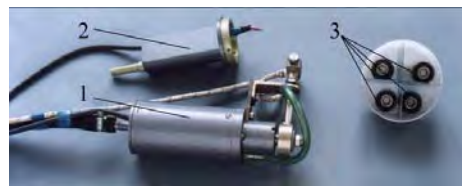
Рис. 2. Внешний вид электромеханического вибратора: 1 – вибратор без съемной рукоятки; 2 – съемная рукоятка; 3 – сменные эксцентрики.
