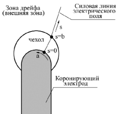
Рис. 1. Интегрирование вдоль силовой линии электрического поля; s – координата вдоль силовой линии; a – координата вдоль поверхности коронирующего электрода, параметризующая силовые линии.
