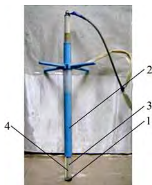
Рис. 4. Электрод. 1 – анод; 2 – катод; 3 – изолятор; 4 – капсула с ВЭС в канале разряда.
