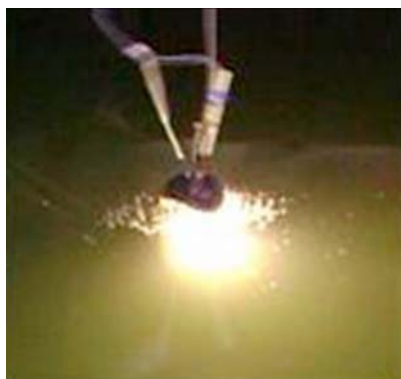
Рис. 6. Испытания ЭС в водной среде с использованием ВЭС массой 32,0 \cdot 10^{-3} кг.
