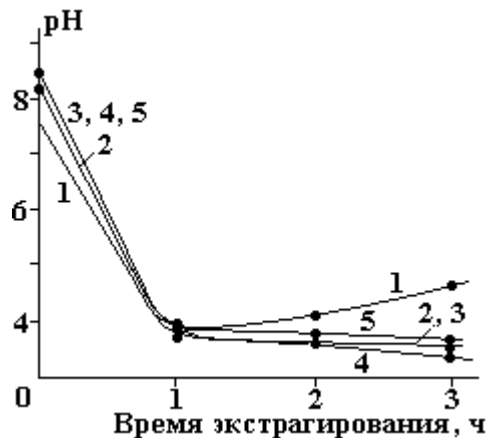
Рис. 4. Влияние добавки Э1, Э2 и Э3 на рН раствора (концентрации ингибиторов – 50 мл/л) при длительности испытаний, ч: 1 – 0; 2 – 24; 3 – 72; 4 – 120; 5 – 240
