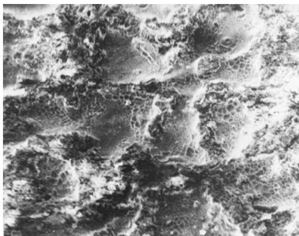
Рис. 14. Морфология поверхности сплава ВНМ-3-2, обработанного в растворе 100 г/л с NaOH добавкой хлористого натрия концентрации, г/л: а – 50; б – 100; в – 200 (x400)
