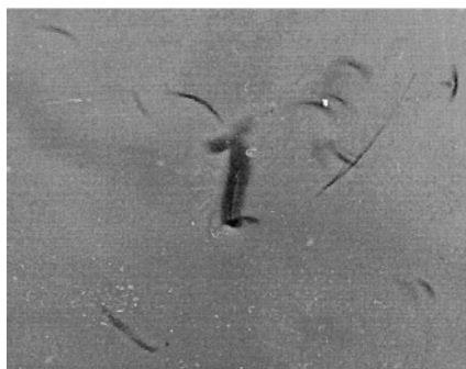
Рис. 5. Затемнение рентгеновской пленки при разряде кавитационной области.
