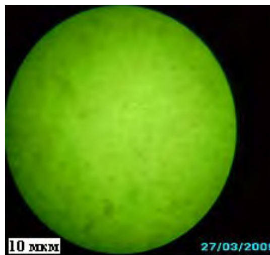
Рис. 4. Микрофотография образца кремния, полученного двухстадийной диффузией гадолиния при относительно низких конечных температурах и времени выдержки
