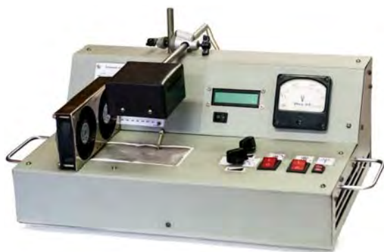
Рис. 5. Установка ИК пайки с верхним средневолновым керамическим излучателем.
