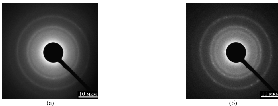
Рис. 3. Электронная дифрактограмма ЛС, полученного электродом Д4: (а) Ti_2B_5 ; (б) SiC.
