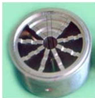
Рис. 25. Анодный блок амплитрона. Высота 50 мм. D = 62 мм, d = 14 мм. Ламели – 4 мм. Вырезано 7 резонаторов
