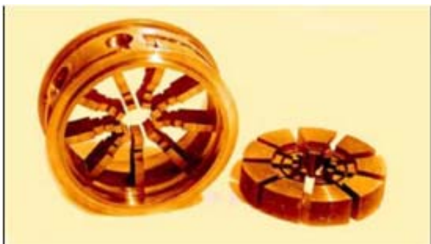
Рис. 24. Анодный блок амплитрона «Салют». Ламели: ширина – 4 мм, высота – 12 мм. D = 62 мм, d = 14 мм. Точность изготовления элементов – 0,01 мм. Справа – отходы
