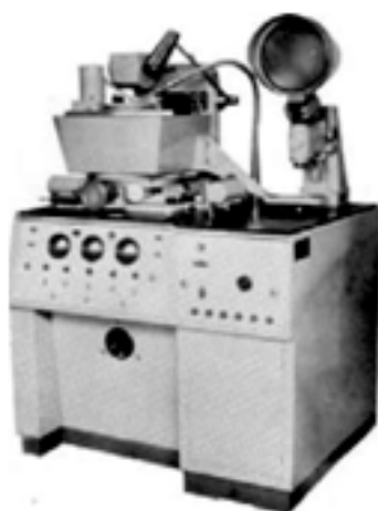
Рис.17. Установка А207.33 со встроенным тиратронным генератором импульсов
