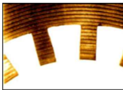
Рис. 13. Фрагмент 10-резонаторного блока толщиной 4 мм ( D = 6,7 мм, d = 5,4 мм, ламели: ширина – 0,4 мм, длина – 0,82 мм)
