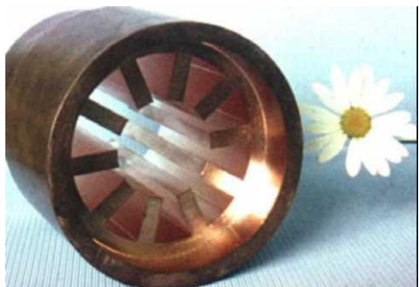
Рис. 26. Анодный блок. Ламели: ширина – 4 мм, высота – 82 мм, d = 24 мм, D = 68 мм
