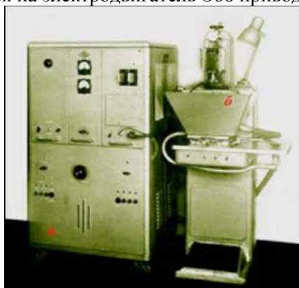
Рис. 20. Тиратронный генератор (а) и экспериментальная установка для изготовления деталей копированием профиля электрода-инструмента с импульсным трансформатором (б), встроенным в ванну
