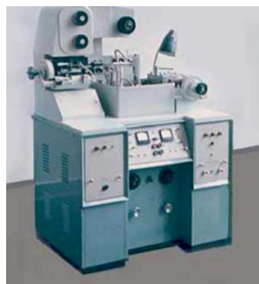
Рис. 16. Электроискровой станок А207.27 для изготовления анодных блоков приборов М-типа двумя проволоками и со встроенным тиратронным генератором импульсов
