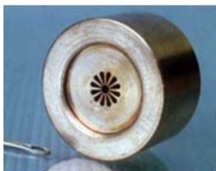
Рис. 28. 12-резонаторный анодный блок «Ро-машка»: d = 0,5 мм, D = 2,5 мм, h = 6 мм
