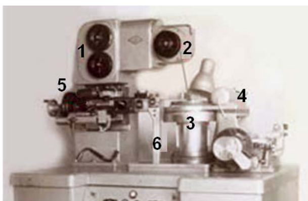
Рис. 15. Электроискровой станок А207.19 для изготовления анодных блоков приборов М-типа двумя проволоками и со встроенным тиратронным генератором импульсов
