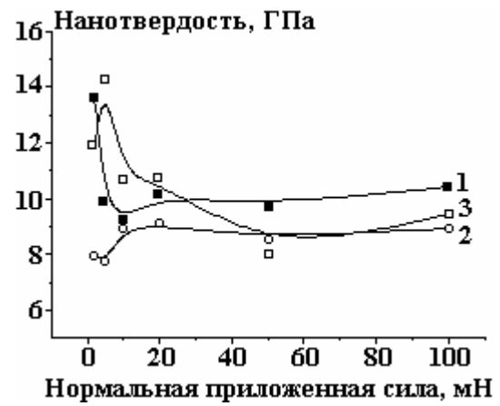
Рис. 4. Нанотвердость, измеренная при различной нагрузке индентора на сплавах Fe-W, Co-W и Cr покрытиях. 1 – Fe-W; 2 – Co-W; 3 – хром
