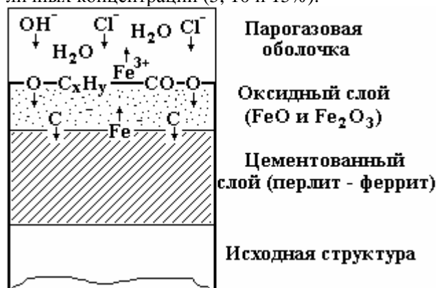
Рис. 6. Схема анодных процессов окисления, растворения и насыщения углеродом при нагреве в водном растворе электролита
