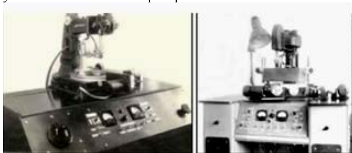
Рис. 12. Первая экспериментальная установка для изготовления анодных блоков приборов М-типа миллиметрового диапазона (слева) и установка ЭКУ-1 (справа) с генераторами РС
