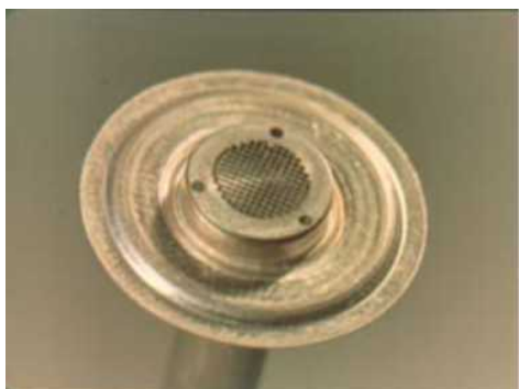
Рис. 7. Сетка \varnothing 7 мм с 152 квадратными отверстиями размером 0,45x0,45 мм и перемычками между ними \leq 30 мкм, изготовленная в диафрагме клистрона
