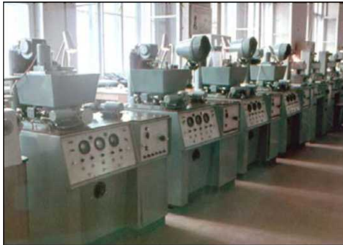
Рис. 22. Группа установок А207.33 со встроенным тиратронным генератором импульсов и сменными приспособлениями для изготовления анодных блоков, катодов и других деталей ЭП
