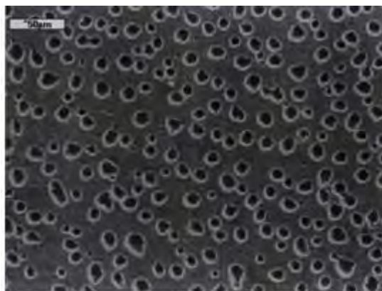
Рис. 2. Фотография приповерхностной области кремния, легированного Ge, после отжига при T=850^{\circ}\text{C} в течение трех часов
