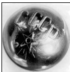
Рис. 4. Сложный профиль, вырезанный в шарике \varnothing 24 мм подшипника электродом-проволокой \varnothing 0,04 мм
