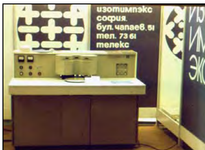
Рис. 20. Установка локального золочения, созданная в БНР с тиратронным генератором НИИ-160, на ВДНХ СССР
