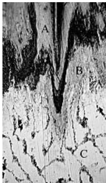
Рис. 6. Структура контактной зоны трения стали 120X15 после работы в индустриальном масле II 20A с наночастицами углерода. Косой шлиф x750
