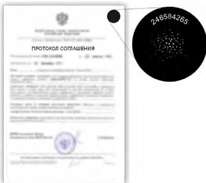
Рис. 2. Документ строгой отчетности с защитой индивидуального цифрового кода электроразрядной технологией
