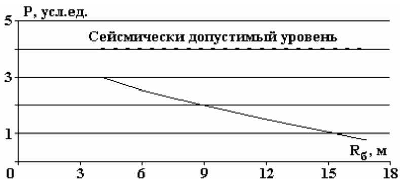
Рис. 2. Зависимость максимального давления волн сжатия от расстояния до точки измерений
