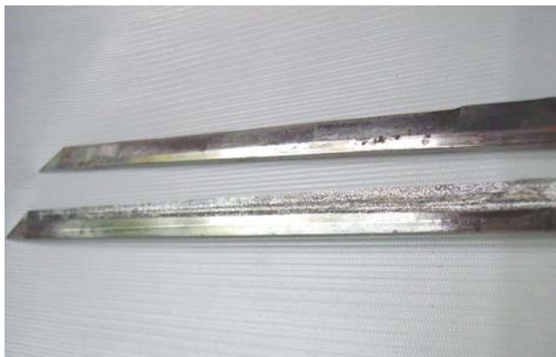
Рис. 4. Лезвия после восстановления поверхности опорной части
