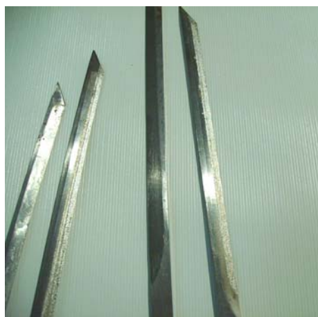
Рис. 4. Лезвия после восстановления поверхности опорной части
