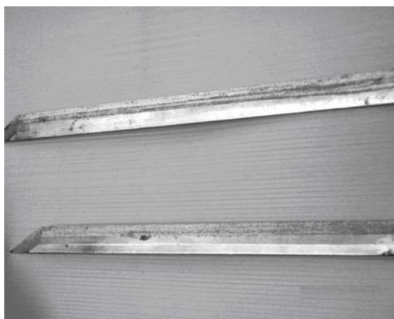
Рис. 4. Лезвия после восстановления поверхности опорной части
