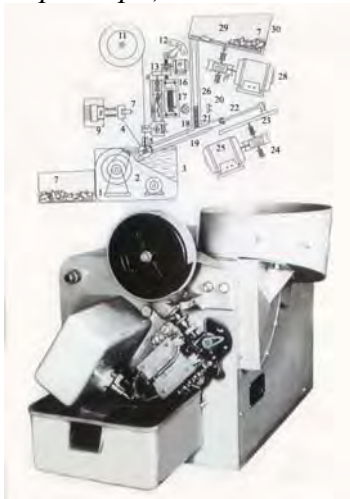
Рис.31 Автомат для электроискровой обработки отверстий \varnothing 0,15 мм
