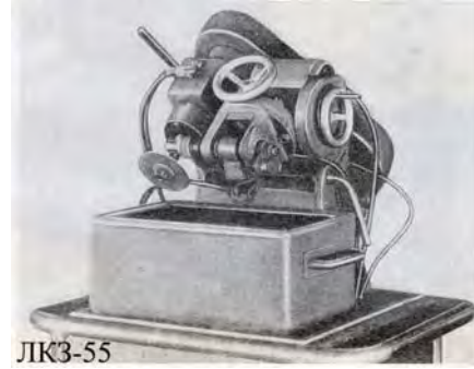
Рис.34 Установка ЛК3-55 для разрезания тонким вращающимся диском
