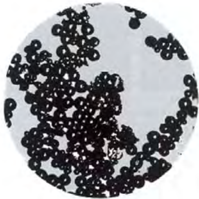
Рис.2 Материал электродов, измельченный электрическими разрядами
