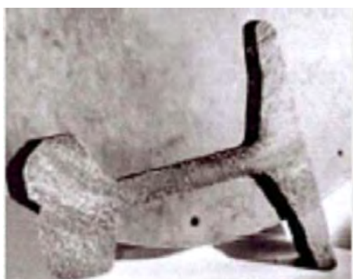
Рис.20 Разрезанный рельс на фоне электрода-диска из кровельного железа
