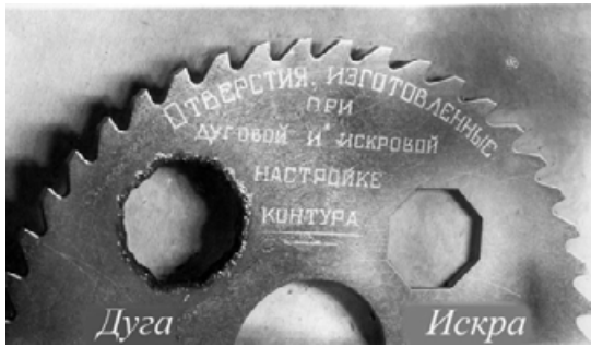
Рис.8 Восьмигранные отверстия, изготовленные в стальной фрезе дуговым и искровым электрическими разрядами
