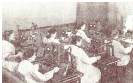
Рис.29 Часть цеха Ленинградского карбюраторного завода, где электроискровым способом изготавливают отверстия в распылителях топлива
