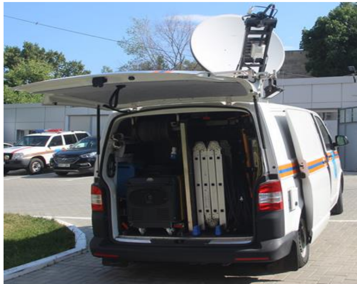
Figura 7. Centru de telecomunicații mobile
