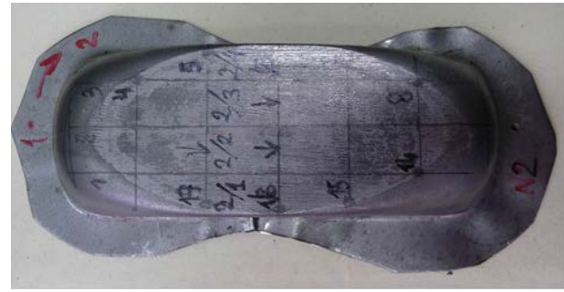
Рис. 7. Деформированный образец №2 с разметкой, перед разрезкой его для изготовления шлифов.
