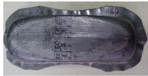
Рис. 9. Деформированный образец №60 с разметкой, перед разрезкой его для изготовления шлифов.
