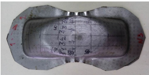
Рис. 8. Деформированный образец №3 с разметкой, перед разрезкой его для изготовления шлифов.
