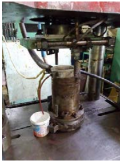
Рис. 6. Разрядная камера с прижимным кольцом в сборе (сверху на подвижной траверсе пресса T1226Б закреплена матрица).
