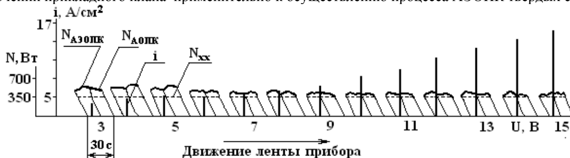
Рис. 5. Плотность технологического тока ( i ) и осциллограммы изменения мощности электропривода ПК при АЭОПК и АОПК с различной величиной напряжения на электродах ( U ). Сплав ВК8, содовый ( Na_2CO_3 - 100 г/л) электролит, n = 2000 об/мин, P = 135 Н
