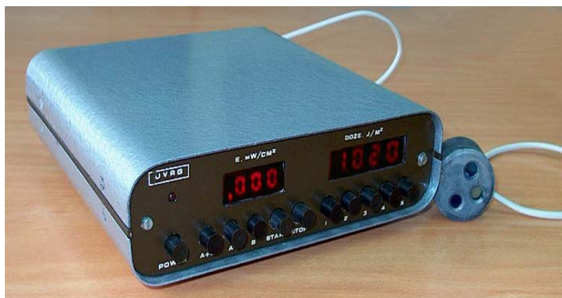
Рис. 4. Прибор с цифровым дисплеем для измерения интенсивности УФ-излучения 10^{-4} – 20 \text{ мВт}/\text{м}^2 . Спектральные области, нм: 280–400, 320–400, 320–360. Доза – 0 – 1,6\cdot 10^5 \text{ Дж}/\text{м}^2 . Рабочее напряжение – 220 В
