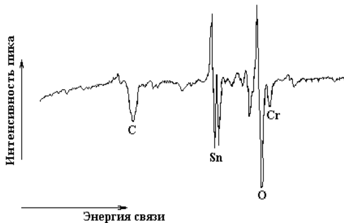
Рис. 5. Оже-спектр поверхности образца 2 без полирования
