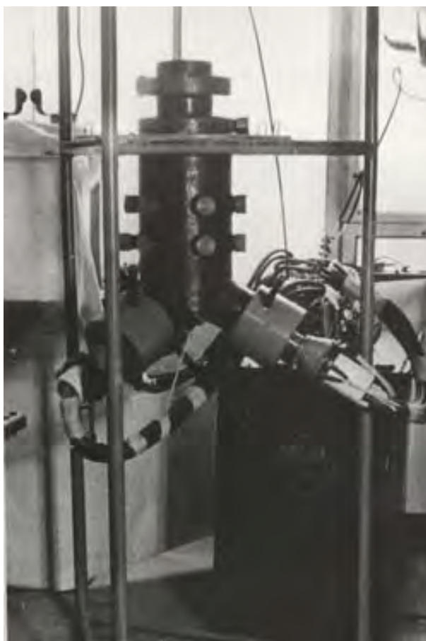
Рис. 1. Лабораторные тришокеры: на основе рельсотронов (а), и коаксиально-цилиндрических плазменных ускорителей (б)
