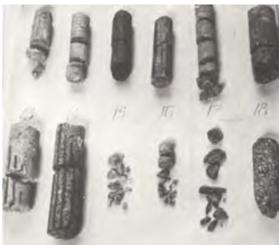
Рис. 2. Керны из различных горных пород, разрушенные в тришокере
