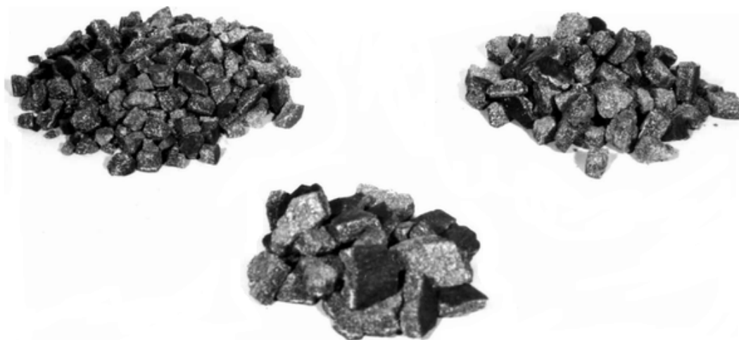
Рис.2. Осколки трубных отложений коксохимического производства после ЭГИ очистки труб
