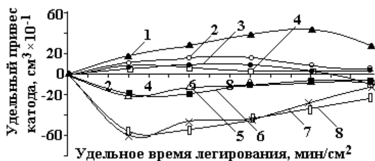
Рис. 1. Удельные изменения масс катодов из стали 45 и масс анодов при ЭИЛ хромоникелевыми сталями и сплавами, металлами Cr и Ni, твердым сплавом ВК8. 1 – X20H80(K); 2 – 12X18H10T(K); 3 – ВК8(K); 4 – Cr(K); 5 – Cr(A); 6 – ВК8(A); 7 – 12X18H10T (A); 8 – X20H80(A)
