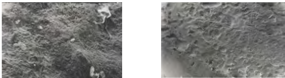
Рис. 9. Морфология поверхности стали 45 после коррозии в 0,05 М Na 2 SO 4 в течение 96 часов: неазотированной (а) и азотированной в электролите 10/5 (б) x 700
