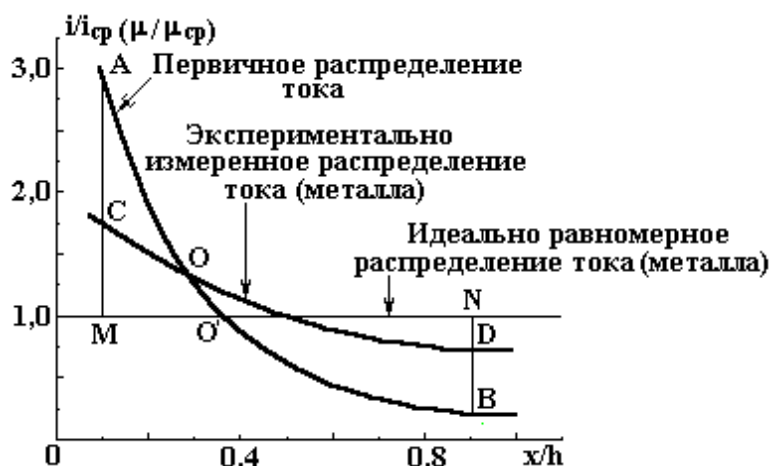
Рис. 1. Схема определения РС с использованием ячейки Хулла (пояснения в тексте)
