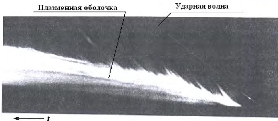
Рис. 2. Продольная фоторазвертка движения плазменного образования и генерируемых им высокоскоростных ударных волн и фронтальной ударной волны
