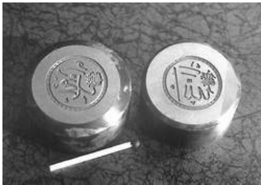
Рис. 11. Матрицы чеканочных штампов (а) и электроды-инструменты для их изготовления (б)
