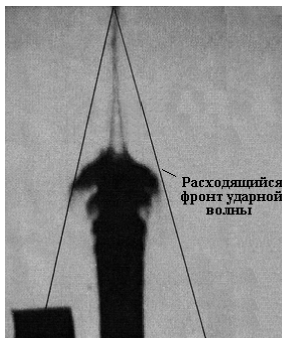
Рис. 3. Схема расходящегося фронта ударной волны, порождаемой при движении со сверхзвуковой скоростью кумулятивной струи
