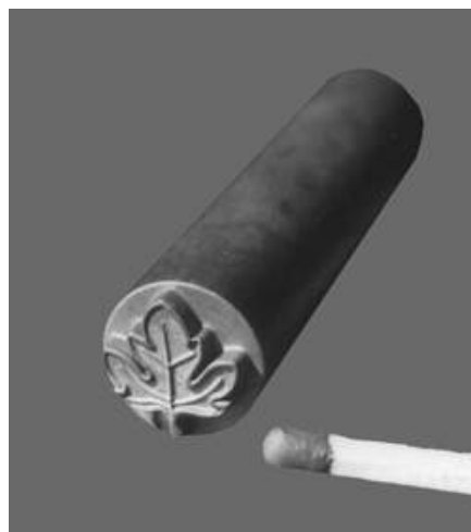
Рис. 12. Электрод-инструмент для изготовления формообразующих поверхностей чеканочного штампа, предназначенного для производства серег
