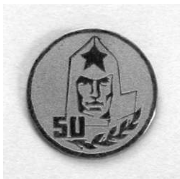
Рис. 4. Образцы значков (а-г) и медали (д), представляющие сквозные сложные профили, вырезанные в заготовках из нержавеющей стали толщиной 1–3 мм
