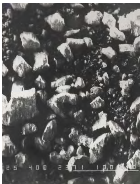
Рис.1. Сканограмма частиц продукта взаимодействия СМП алюминия с водой после полного завершения реакции ( \times 400 )
