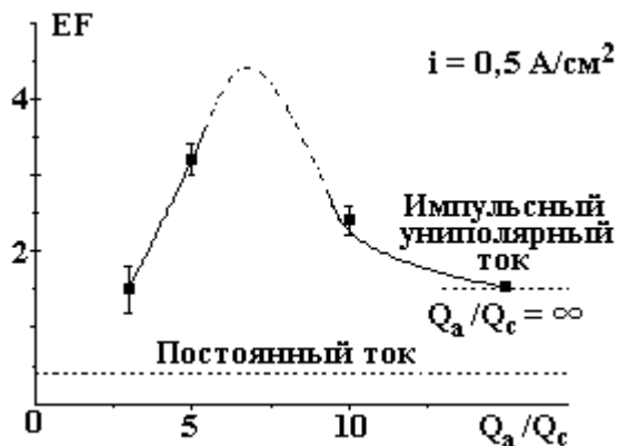
Рис. 6. Зависимость локализации травления от отношения плотностей пропущенного заряда в анодном и катодном импульсах при i = 1,0 \text{ A/cm}^2
