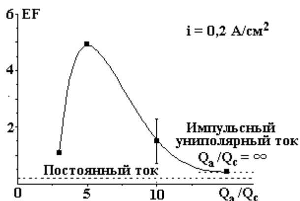
Рис. 4. Зависимость локализации травления от отношения плотностей пропущенного заряда в анодном и катодном импульсах при i = 0,2 А/см 2
