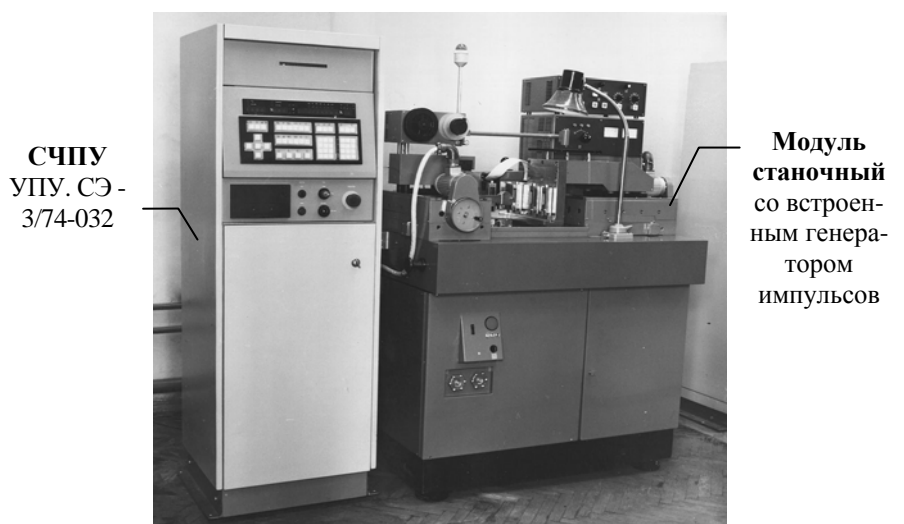
Рис. 9. Электроискровой комплекс «Электроника-04ИВ-250» модели А207.79: а – система ЧПУ 15ИПЧ-3-001 (И5М1.409.006); б – станочный модуль 04ИВ-250; в – генератор импульсный тиристорный А671.57.
