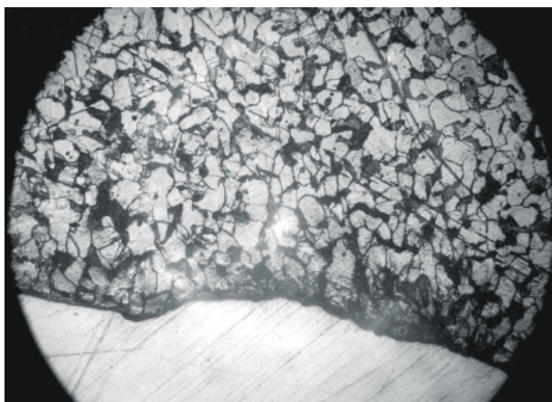
Рис. 3. Микрофотография поперечного сечения границы запрессовки.
