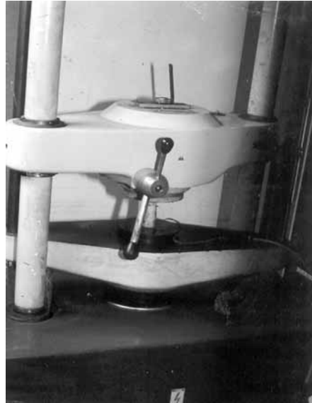
Fig. 9. Test de compresiune, diafizara.
