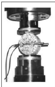
Figura 5. Utilajul pentru testarea la despicare indirectă
