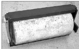
Figura 6. Exemplu de configurație a epruvetei pentru testarea la despicare indirectă
