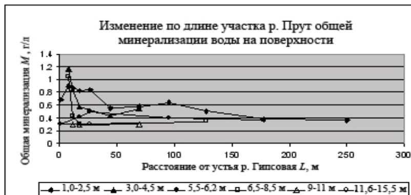
Рис. 5. Изменение общей минерализации поверхностной воды по длине р. Прут от устья р. Гипсовая.
