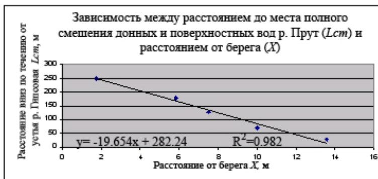
Рис. 7. Связь между протяженностью зоны смешения придонных и поверхностных вод и расстоянием от берега.
