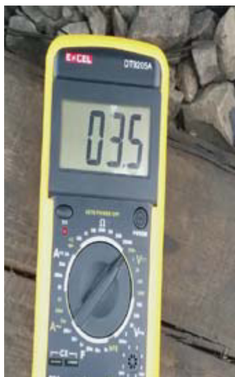
Fig. 5. Tensiunea dintre două șine de cale ferată este de 3,5V
