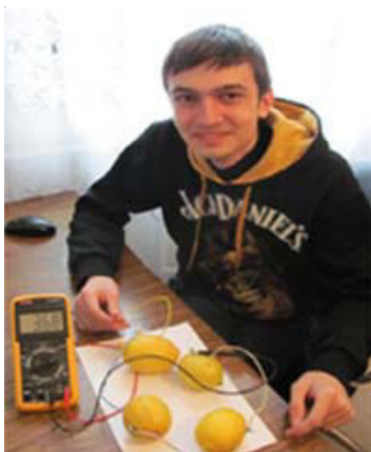
Fig. 2. Patru lămâi conectate în serie dau o tensiune de 3,68-3,69 V. Elevul clasei a XI-a Procopovici Dumitru în rol de experimentator. Liceul Teoretic „Mihai Eminescu” din Bălți, Republica Moldova
