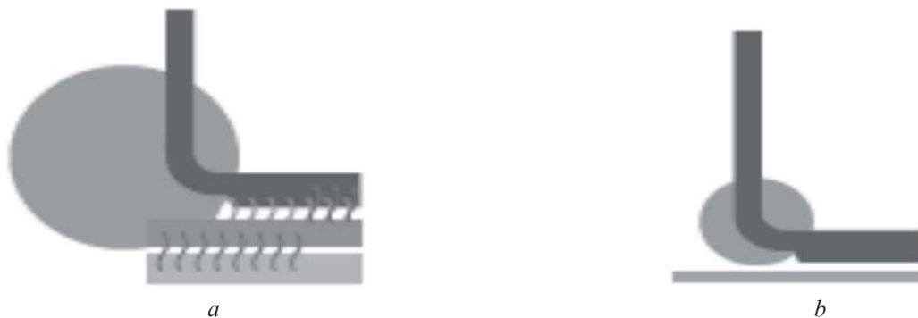
Fig. 6. Aria degajării căldurii la plita electrică (a) și cea cu inducție (b)
