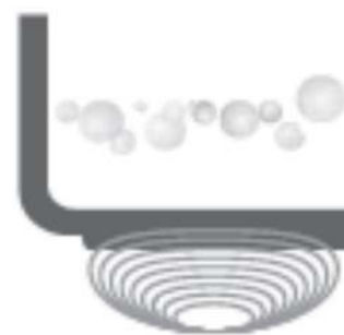
Fig. 3. Curenții turbionari în plita cu inducție
