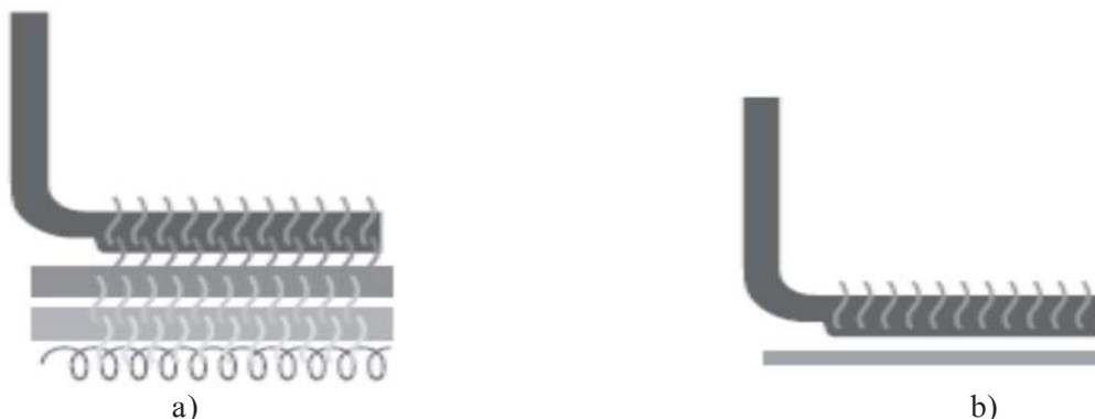
Fig. 2. Plita electrică (a) și plita cu inducție (b)
