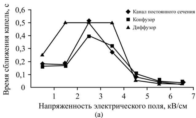
Рис. 9. Влияние угла раскрытия электродов на среднее время сближения капель.
