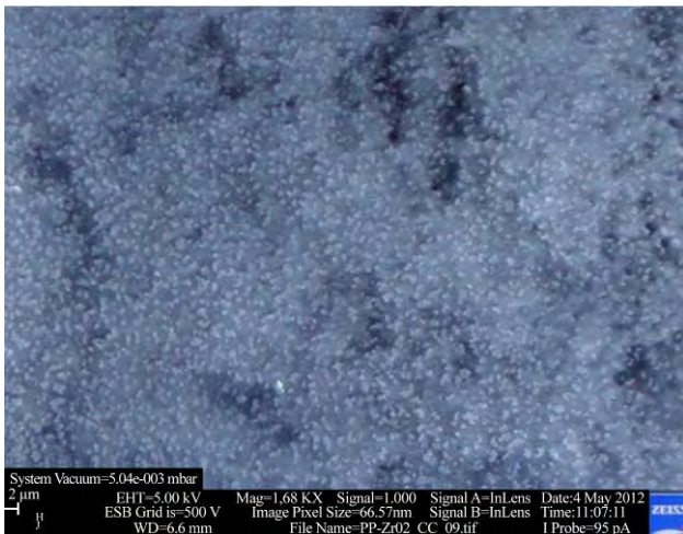
Рис. 3. Электронно-микроскопическое изображение нанокомпозитов на основе ПП+ZrO 2 (облучение поверхности пучком первичных электронов с энергией 5 кэВ).
