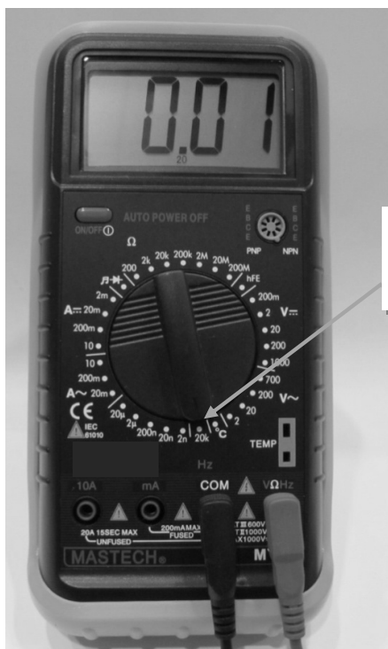
FIGURA 3 Multimetru digital pentru măsurarea frecvenței
