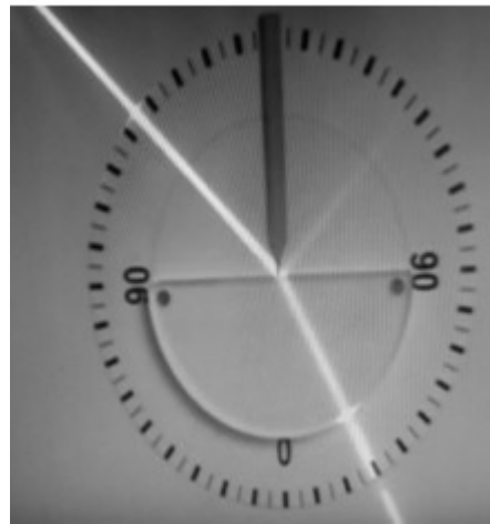
Fig. 7. Demonstrarea refracției luminii pe masa orizontală [9]
